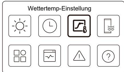
Die Soll-Wassertemperatur wird automatisch in Abhängigkeit von der Außentemperatur geregelt.
